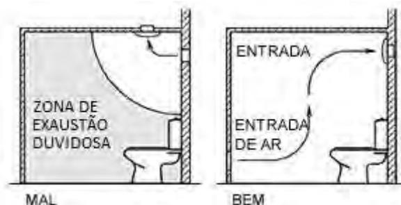
**Figura 2.5- Exemplo de ventilação em WC**
