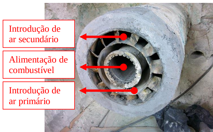
Fig. 4.25 – Queimador do forno de branco
