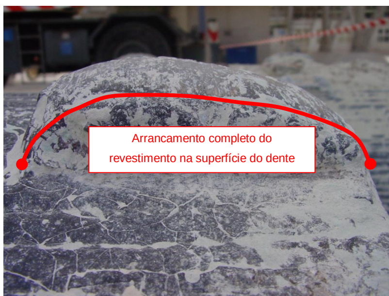
Fig. 5.13 – Arrancamento completo do revestimento na superfície do dente
