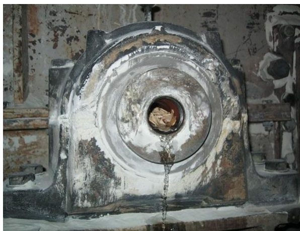
Fig. 6.6 – Presença de calcário à saída do veio
