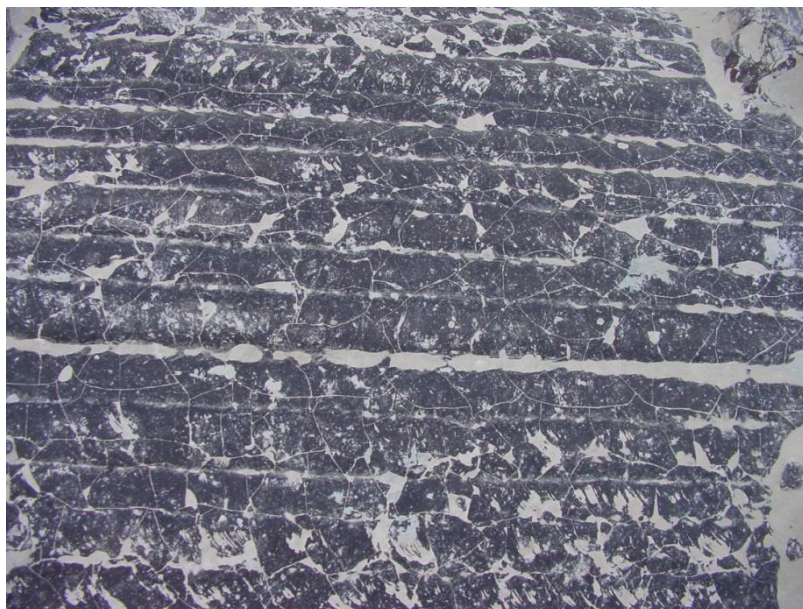
Fig. 5.14 – Fenómeno de fissuração a frio na superfície do rolo de compressão
