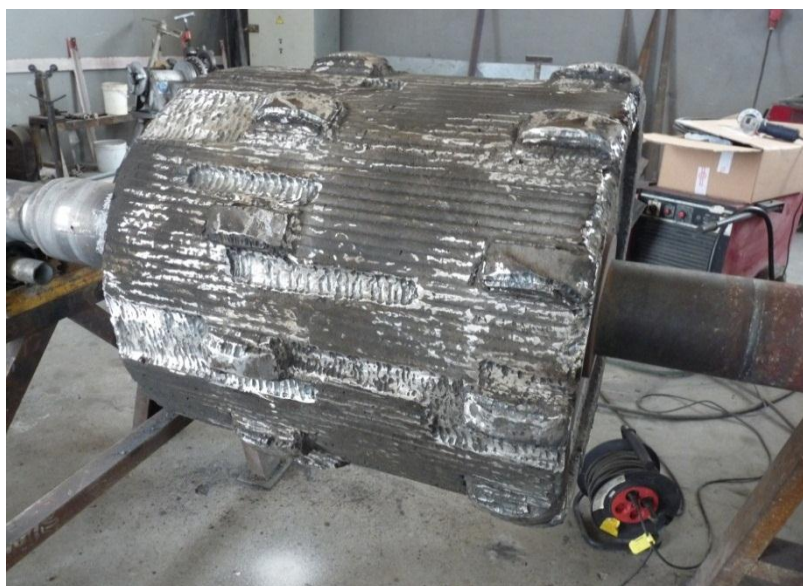
Fig. 6.1 – Superfície do rolo após preparação
