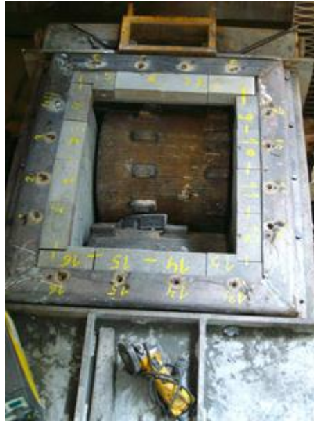
Fig. 5.8 – Vedação entre funil superior e tampa superior
