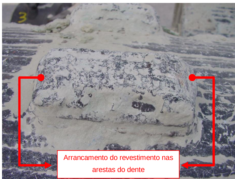
Fig. 5.12 – Arrancamento do revestimento nas arestas do dente
