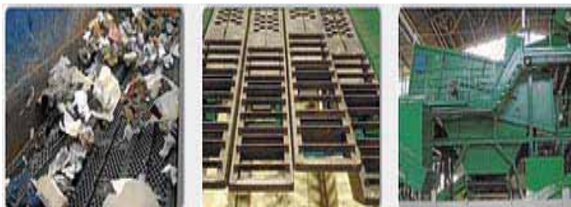
Figura 30 – Separador balístico (Ambirumo)
