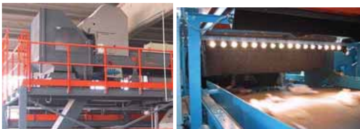
Figura 31 – Separador óptico (Ambirumo)
