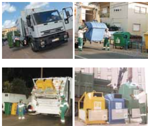
Figura 7 – Exemplo de viaturas utilizadas na recolha em função da tipologia de contentores (SMAS Loures)
